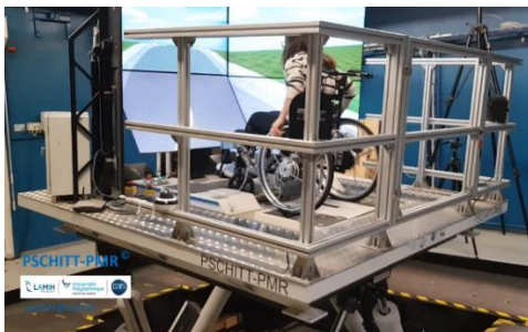
Simulateur dynamique de FRM PSCHITT-PMR, laboratoire LAMIH, Valenciennes.
